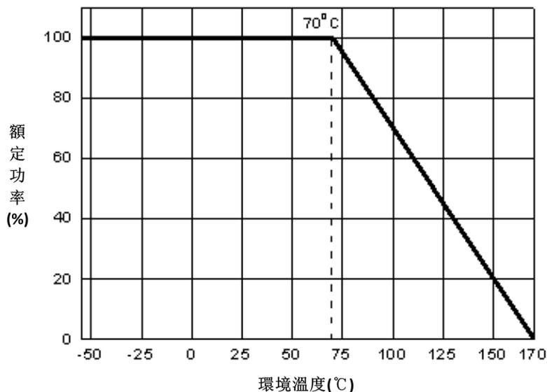
工作温度范围（Operating Temperature Range）：  $-55^{\circ}\text{C}\sim+170^{\circ}\text{C}$ ；
